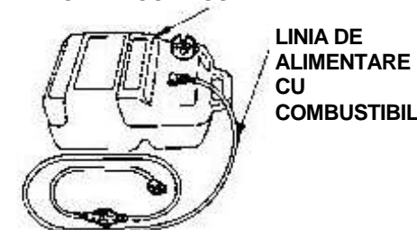
REZERVOR DE COMBUSTIBIL
