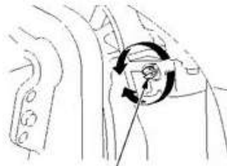
ȘURUBUL PT. REGLAREA FRECĂRII ÎN COLOANA DIRECȚIEI
